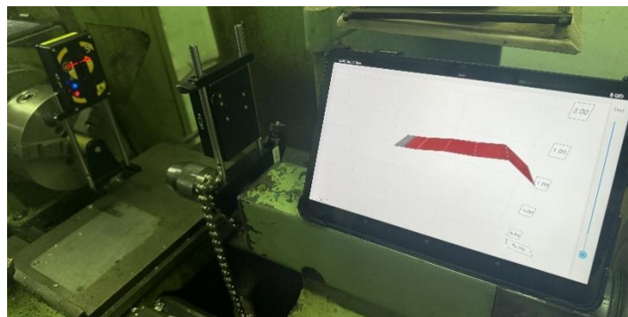
Рисунок 10. Пример проведения замера прямолинейности хода задней бабки
