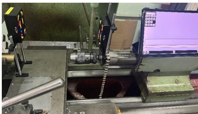
Рисунок 7. Установка S и проведение замера, смещение пиноли
