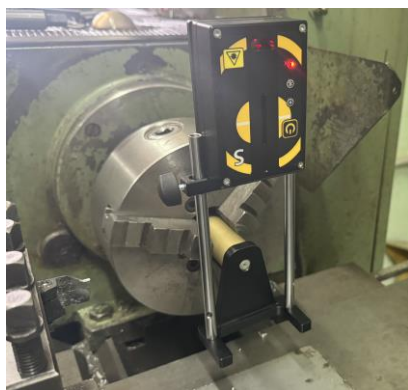
Рисунок 7. Установка S и проведение замера, смещение пиноли
