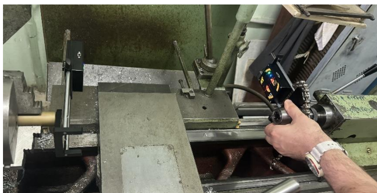
Рисунок 4. Установка S и проведение замера, поворот M и S
