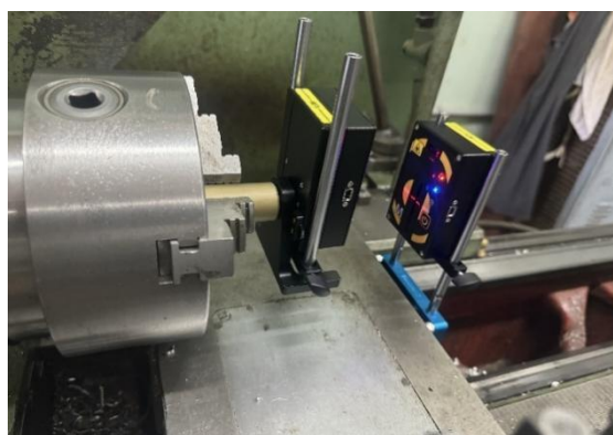
Рисунок 7. Установка S и М, проведение замера, смещением суппорта
