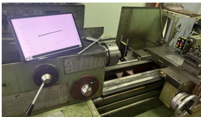
Рисунок 10. Пример проведения замера прямолинейности хода суппорта
