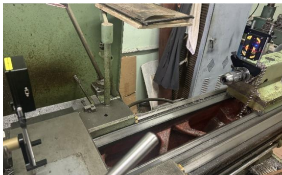
Рисунок 10. Пример проведения замера прямолинейности хода задней бабки
